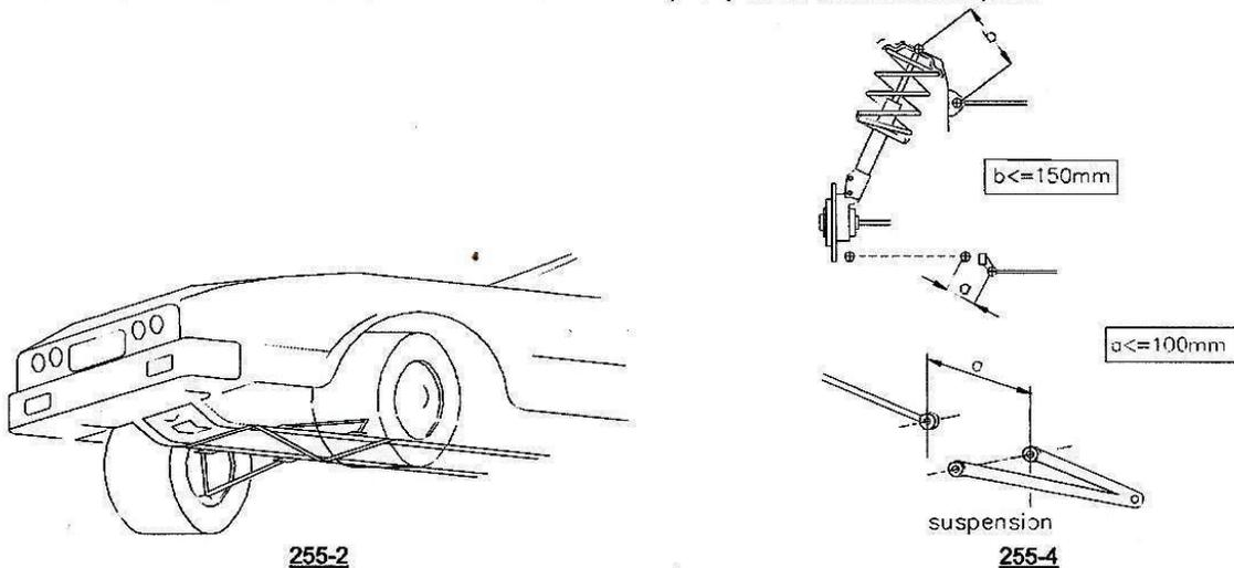
Si el vehículo de serie está equipado con una barra de refuerzo, se permite quitarla o reemplazarla de acuerdo con las prescripciones anteriores. Se permite el refuerzo de la parte suspendida, a condición de que el material utilizado siga la forma original y esté en contacto con ella.
