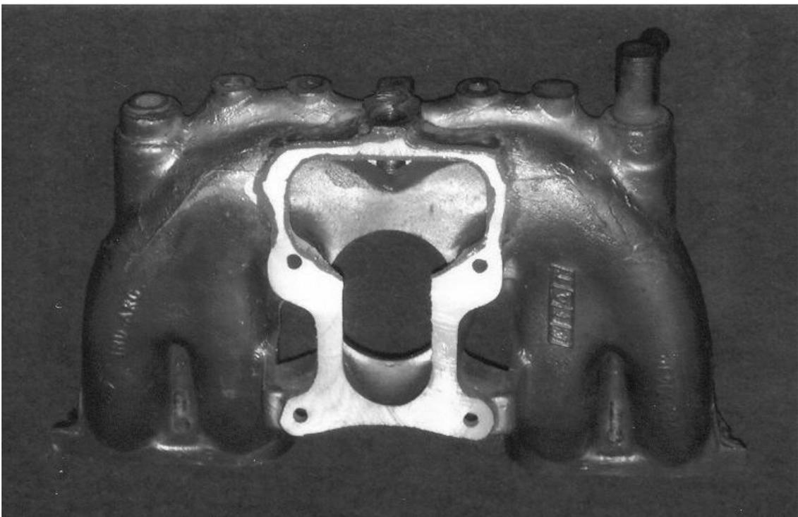
2. Para la línea FIAT de 1.600 cc. de ocho (8) válvulas, se permite colocar el múltiple de admisión según plano adjunto:
